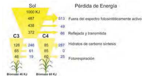
Figura 05 Mínimas pérdidas de energía calculada para 1000 kJ de la radiación solar para la fotosíntesis de las plantas C3 y C4
